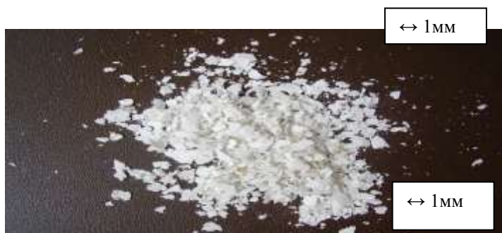
Рис. 4. Сепароване, подрібнене ПВХ полімерне покриття з шпалер (розмір частинок d = 0,1-5 мм), що складаються з (ПВХ, пластифікатори, пігменти, наповнювачі, крейда).
