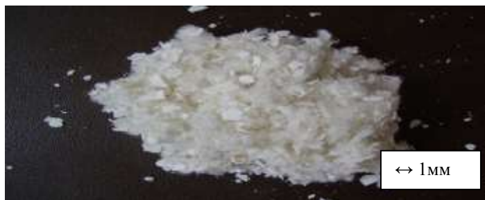
Рис. 2. Не сепаровані подрібнені паперові відходи з бракованих рулонів шпалер з полімерним (ПВХ) покриттям, що містять папір (целюлозу) або флізелін та полівінілхлорид у співвідношенні (50–60): (50–40) %.
