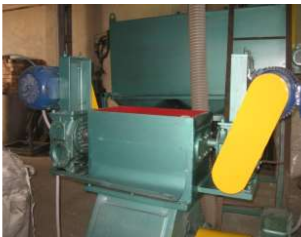
Рис.1. Фото універсальної дробарки-сепаратора типу ДС-150 «ІМЕКС», для розділення полімервмісної макулатури (шпалер, упаковки ТЕТРАПАК) на отримання двох фракцій: 1 – сипуча целюлоза-ековата, як теплоізоляційний матеріал для утеплення житлових приміщень в будівництві, а 2 – фракції подрібнених полімерів ПЕ, ПВХ.
