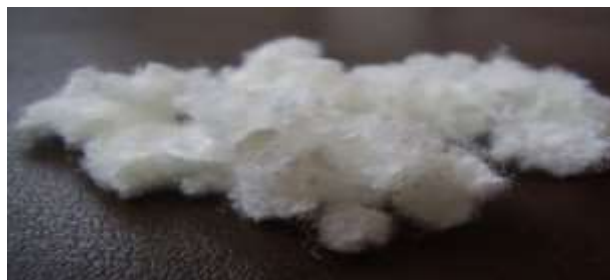
Рис. 4. Сепароване, подрібнене ПВХ полімерне покриття з шпалер (розмір частинок d = 0,1-5 мм), що складаються з (ПВХ, пластифікатори, пігменти, наповнювачі, крейда).
