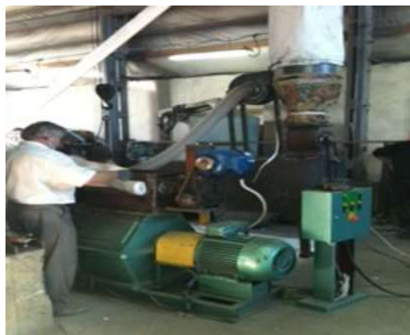
Рис.1. Фото універсальної дробарки-сепаратора типу ДС-150 «ІМЕКС», для розділення полімервмісної макулатури (шпалер, упаковки ТЕТРАПАК) на отримання двох фракцій: 1 – сипуча целюлоза-ековата, як теплоізоляційний матеріал для утеплення житлових приміщень в будівництві, а 2 – фракції подрібнених полімерів ПЕ, ПВХ.
